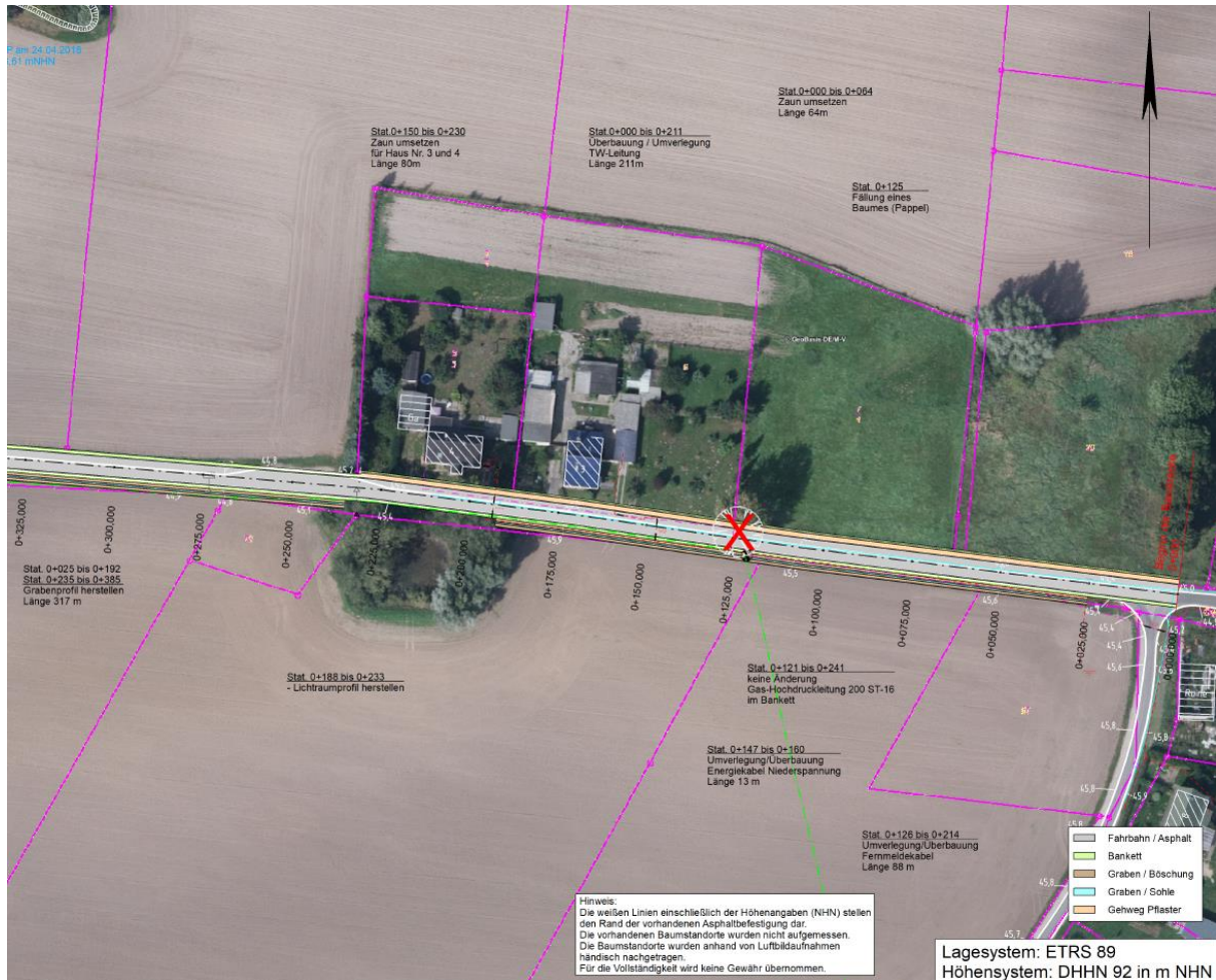
Abbildung 4: Variante 2.1 – Verbreiterung nördlich mit Gehweg
