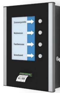
Abb. 8 Das Modell MITRIX als Wandgerät mit vier Knöpfen für die Wartemarken-Ausgabe.
