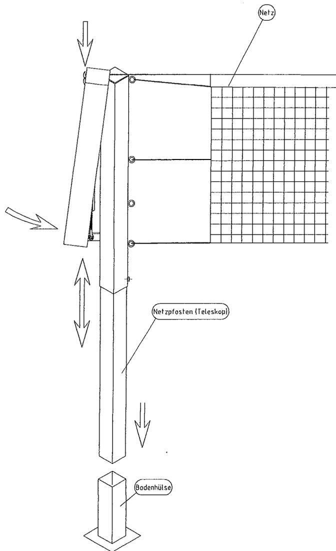
Skizze 3, Säule ausgefahren auf Volleyballhöhe, Abdeckung aufgesetzt und mit Schloss verriegelt:
