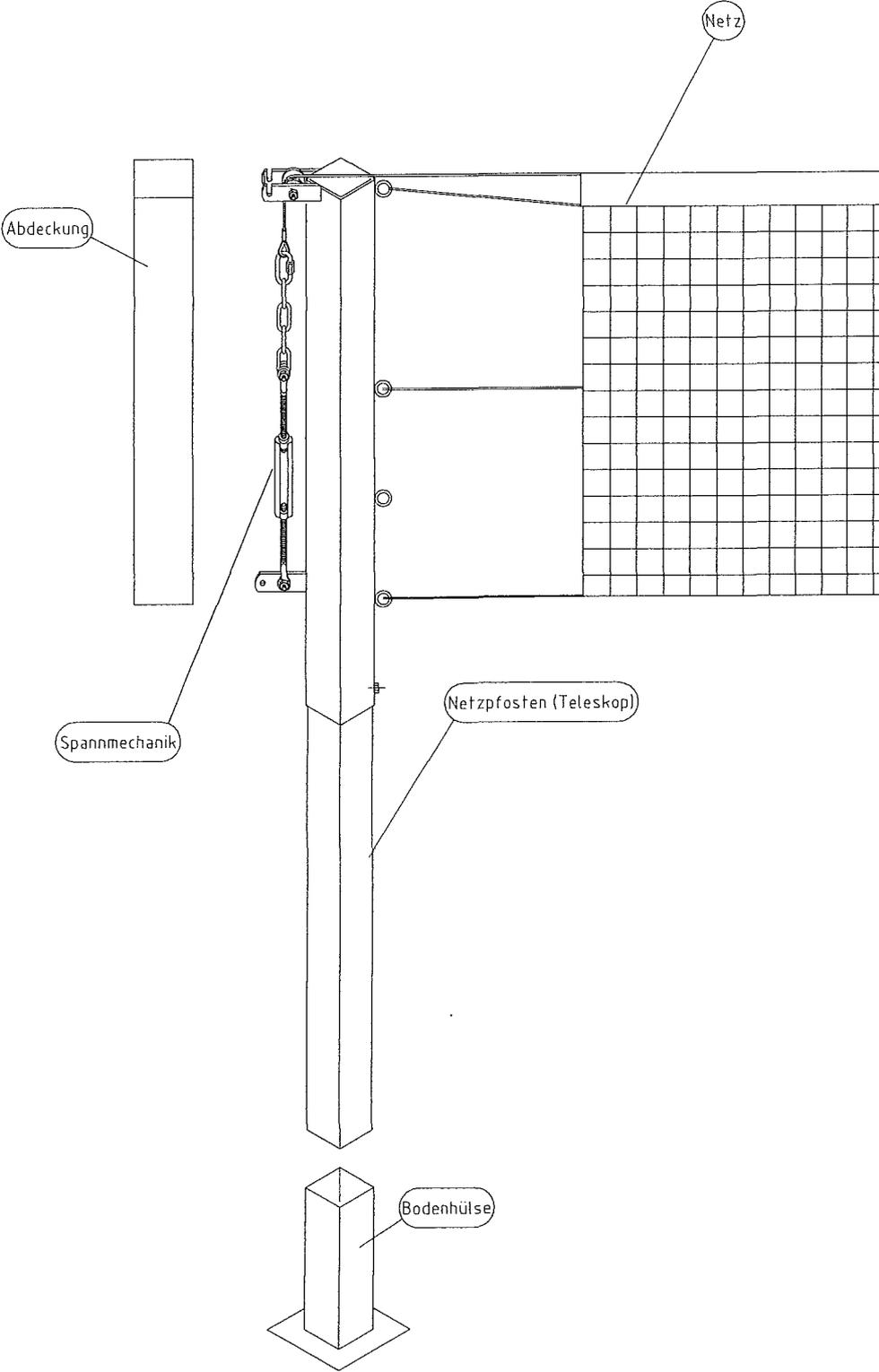
Skizze 2, Säule ausgefahren auf Volleyballhöhe, Abdeckung halb aufgesetzt:
