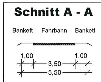
Abb. 2 – einstreifiger Querschnitt
