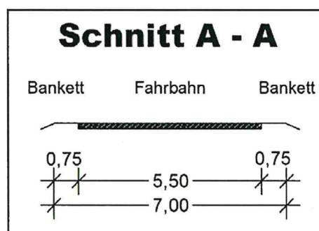
Abb. 3 – zweistreifiger Querschnitt
