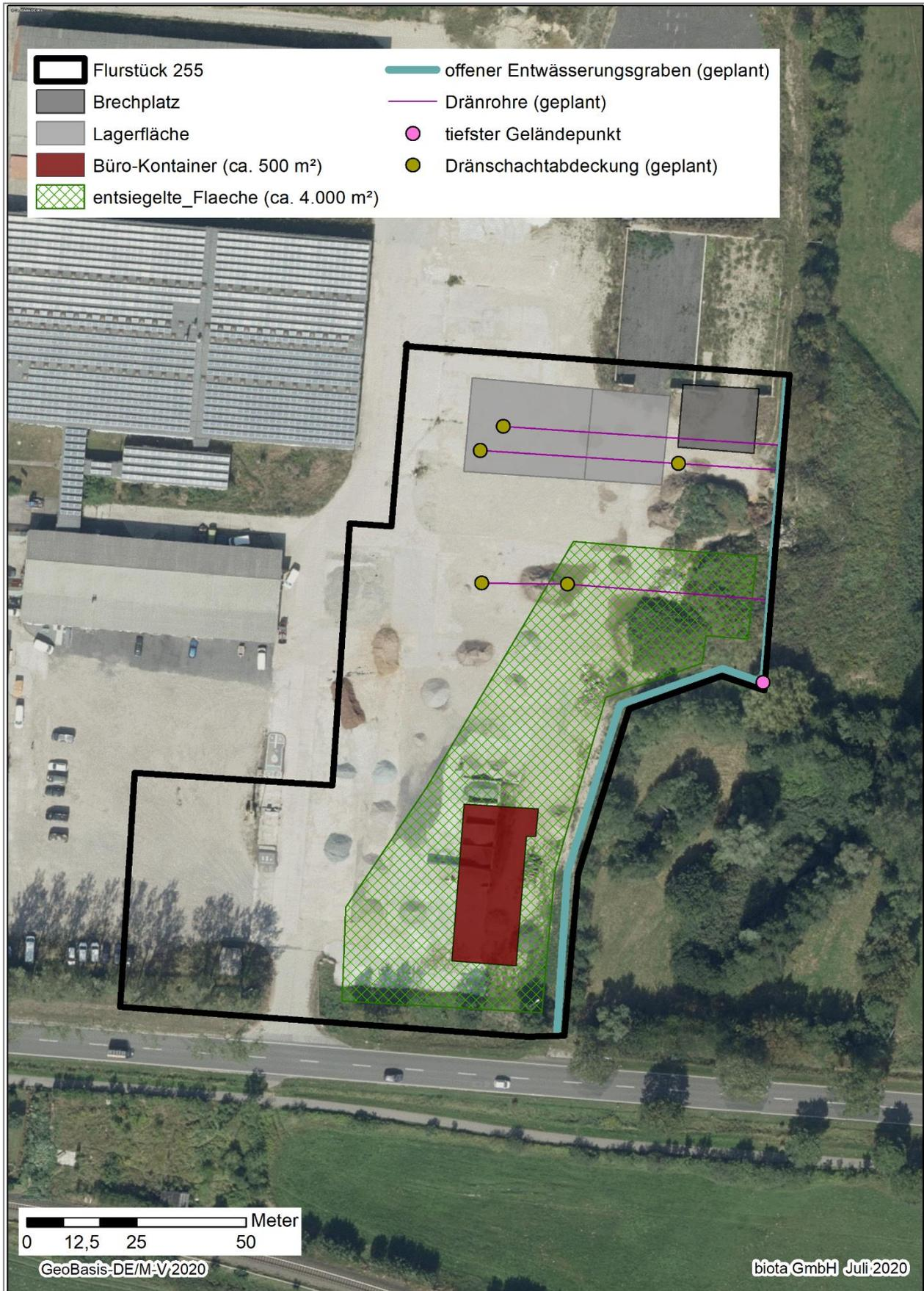
Abbildung 3-1: Entwässerungs- und Behandlungsanlage für Niederschlagswasser vom Betriebsgelände der Hagemann GmbH in Broderstorf
