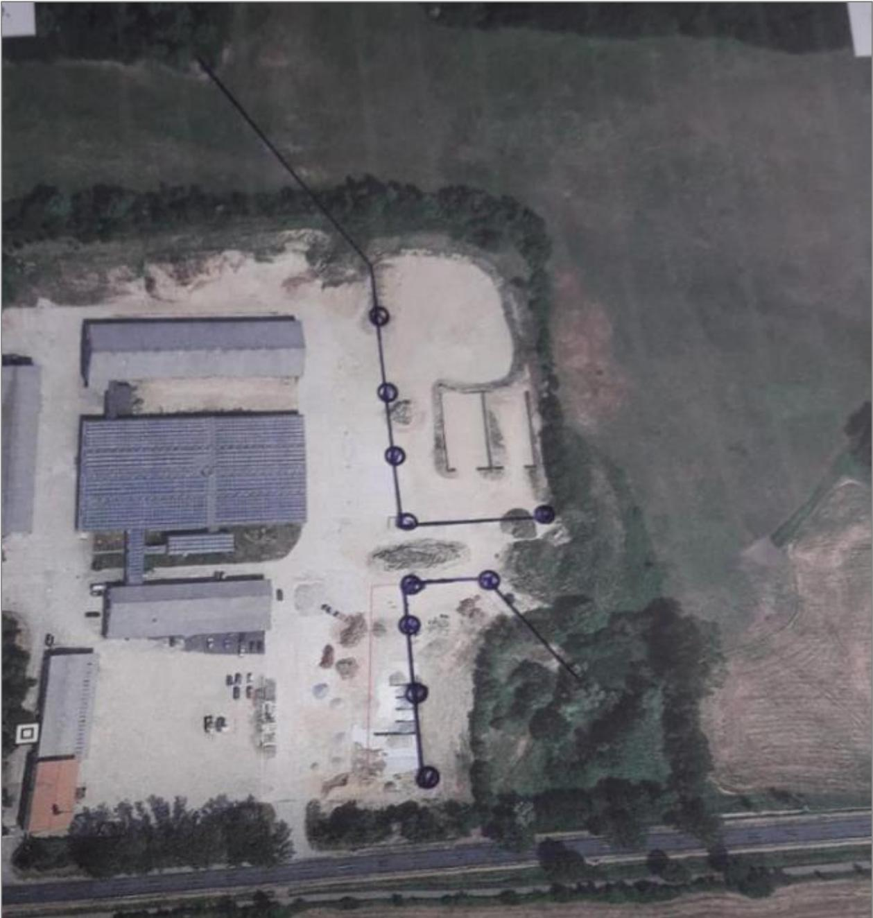
Abbildung 1-2: Skizze des bestehenden Entwässerungssystems
